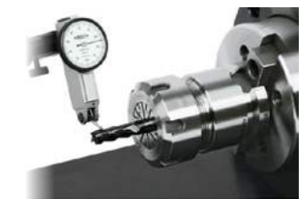
измерение радиального биения торцевой фрезы
