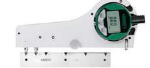
Шаг 1: установка нуля на стандартном блоке
