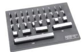
Набор концевых мер длины 2 класса точности
