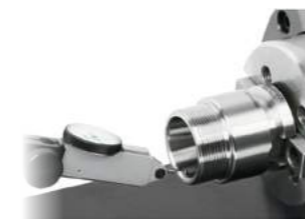
измерение радиального биения хвостовика
