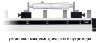
установка микрометрического нутромера
