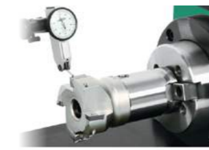
измерение радиального биения фрезы
