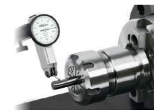
измерение радиального биения цанги
