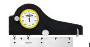
Шаг 1: установка нуля на стандартном блоке
