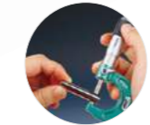
трещотка на барабане для работы одной рукой
