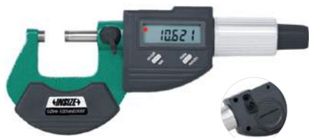
вывод данных на задней стороне
